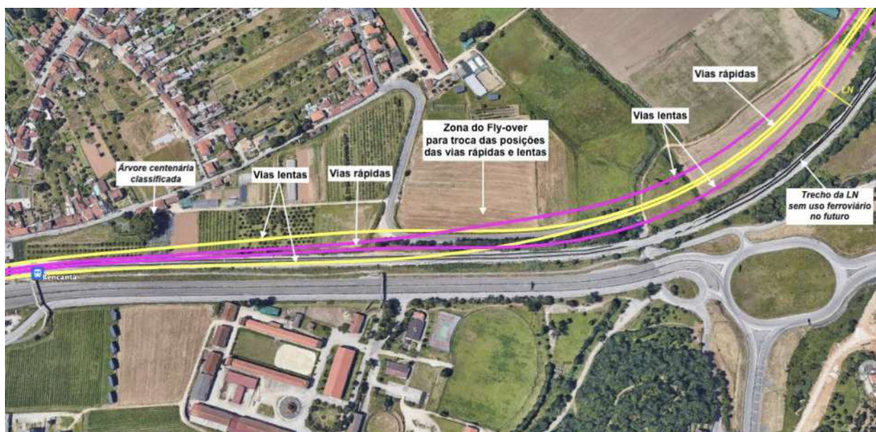
Figura 3.47 – Zona do Fly-over entre Bencanta e Coimbra B
