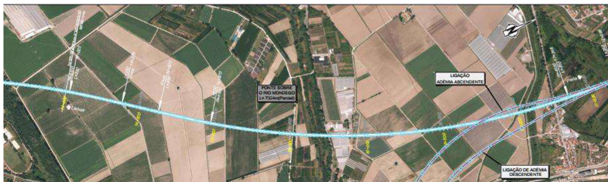
Figura 4.113 – Passagem dos Eixos 3.1 e 3.2 e das Ligações à LN na Adémia, em viaduto, sobre os campos do Mondego
