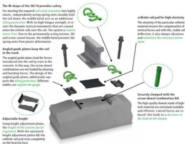
Figura 3.15 – Fixações Tipo VOSSLOH W14
